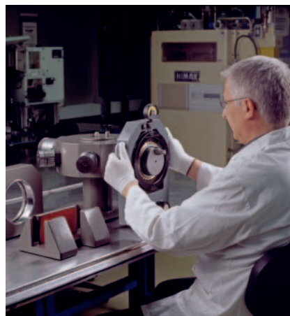
11: Posicionar el instrumento de medición del círculo límite
