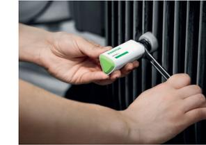
Os sensores fixam-se às unidades através de parafusos ou adesivos, e ativam-se através de uma comunicação de campo próximo (Near-field communication, NFC).
