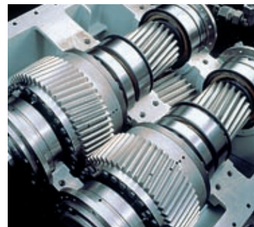
Reductor del laminador, con rodamientos de rodillos cónicos y rodamientos de rodillos cilíndricos
