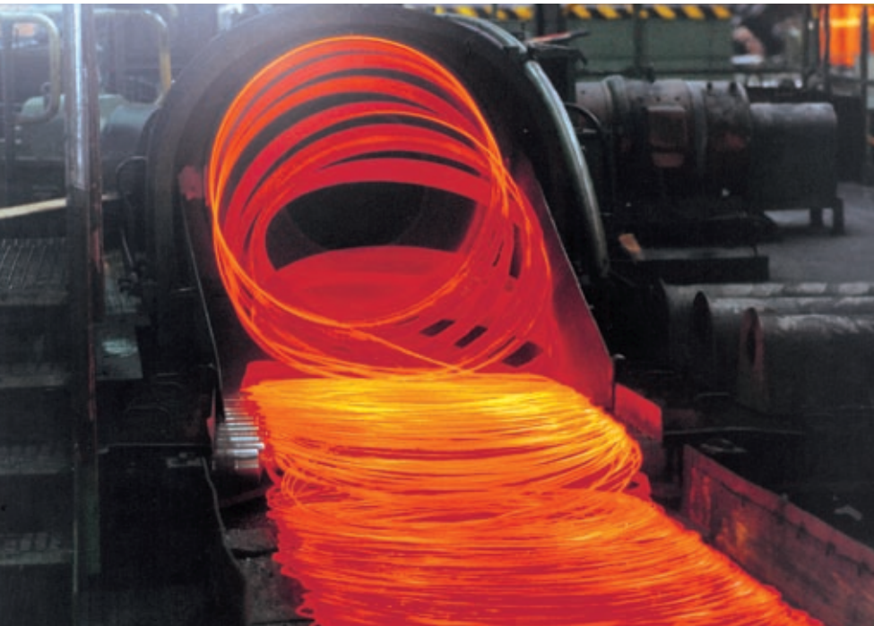
Cabezal de bobinado de cable con rodamientos especiales de rodillos cilíndricos, rodamientos a bolas de contacto angular y rodamientos para husillos
