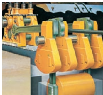
Laminador en paso de peregrino para laminar tubos sin soldadura, con rodamientos especiales oscilantes de rodillos
