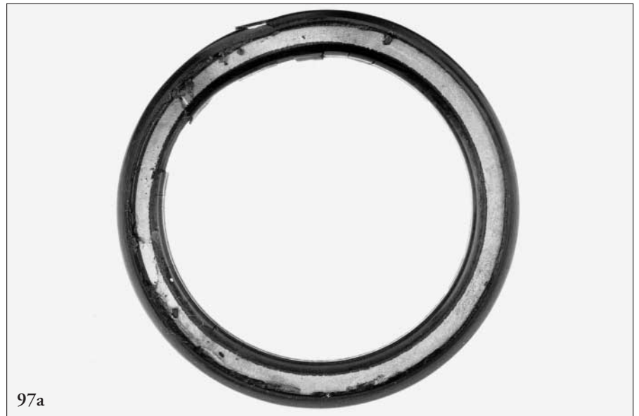
97a: Obturación endurecida con desgaste y roturas
