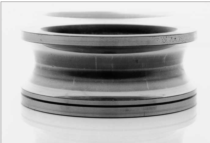
28: Huella de rodadura con desgaste superficial
