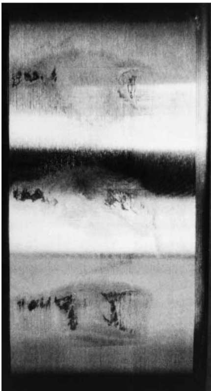
18: Diámetro exterior del aro exterior, oxidación de ajuste en “puntos duros” (p. ej., nervaduras) en el alojamiento
