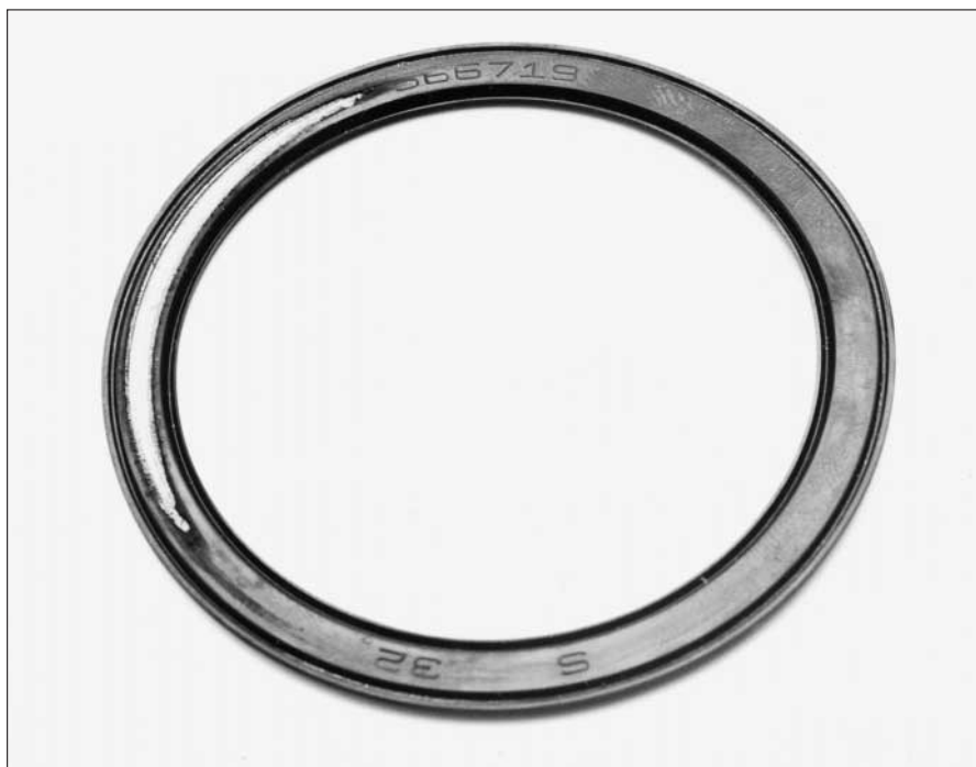
22: Deterioro de la obturación por rozamiento lateral
