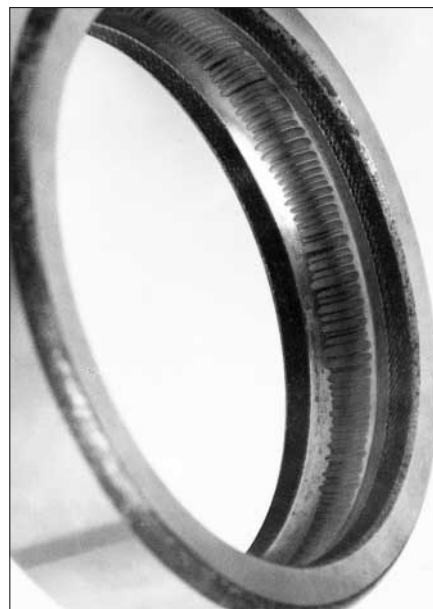
59: Las descargas eléctricas han dado lugar a la formación de cráteres en el camino de rodadura de un rodamiento de rodillos cilíndricos.
