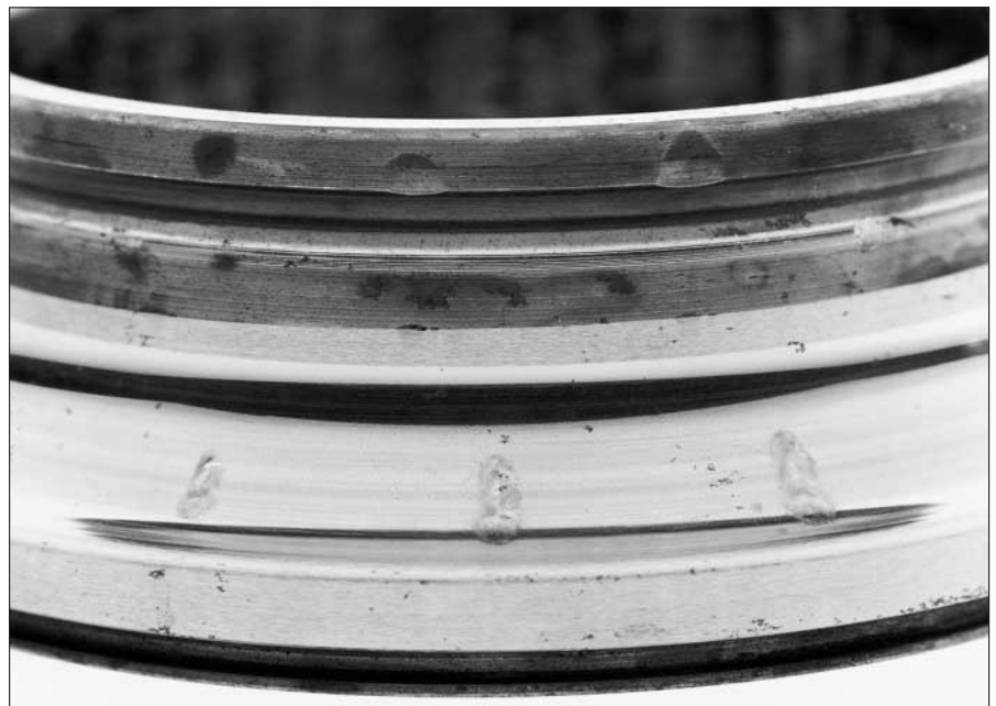
57: Falso brinelling en un rodamiento de bolas
