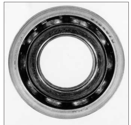
17: Estrías circunferenciales y soldaduras en frío en la superficie frontal del aro interior como consecuencia del giro relativo del aro interior sobre el eje
