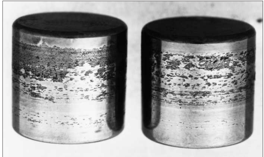
74: Huellas de deslizamiento en rodillos cilíndricos
