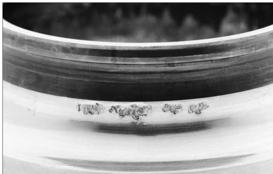
46: Deterioro por fatiga en el fondo de la garganta del aro interior de un rodamiento de bolas de contacto angular, como consecuencia de una fuerza de ajuste insuficiente
