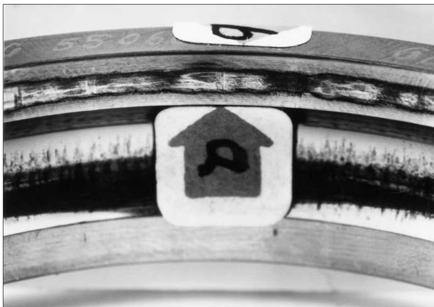
86: Marcas de rozamiento en la superficie de guiado de la jaula de un aro exterior con material adherido
