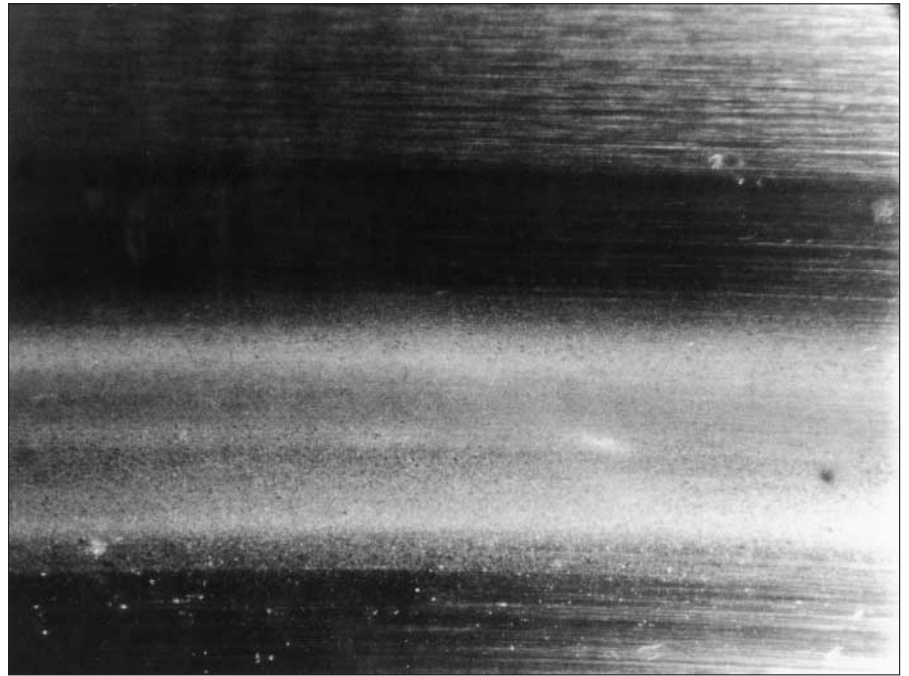
66: Camino de rodadura gastado, rugoso
