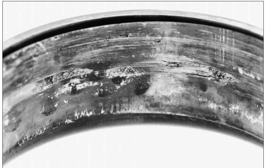
16: Huellas de gripado en el agujero del aro interior como consecuencia del giro relativo del aro interior sobre el eje
