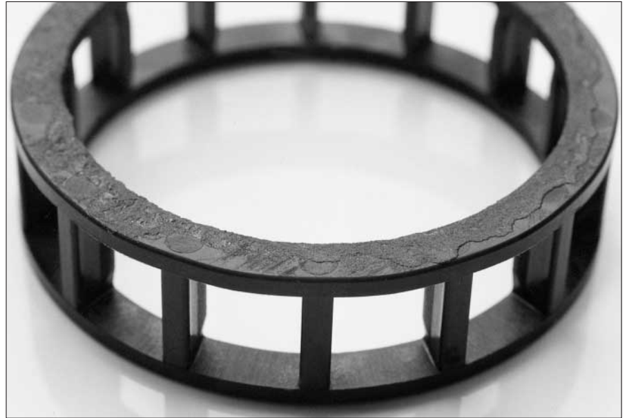
94: Jaula de poliamida con uniones por fusión en caso de calentamiento inadecuado del rodamiento sobre una placa de calentamiento
