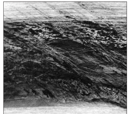
82: En la cara frontal de los rodillos y en el borde puede producirse desgaste por atascamiento en caso de suministro deficiente de lubricante y cargas elevadas.
