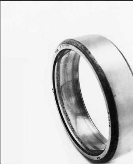
36: Exfoliación producida por precarga axial en el camino de rodadura del aro exterior de un rodamiento oscilante de bolas
