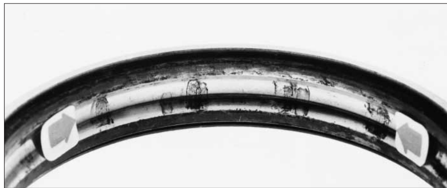
54: Excoriaciones producidas por oxidación en el camino de rodadura a la distancia de los cuerpos rodantes
