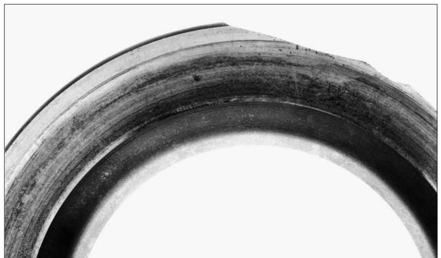
20: Rotura en el borde del aro interior de un rodamiento de rodillos cónicos a consecuencia de un apoyo axial insuficiente de la superficie frontal
