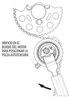
Fig. 7 - GIRAR EL EJE DE INSTALACIÓN DEL AUTOTENSOR EN SENTIDO HORARIO
