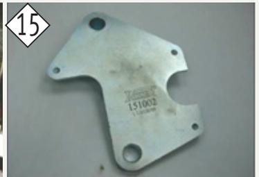
6 - Trabar los engranajes de los comandos con la herramienta N° 151002 (Figuras 15, 17, 18 y 19), para soltar las tuercas, evitando de esta manera el esfuerzo excesivo en los ejes-comando.
