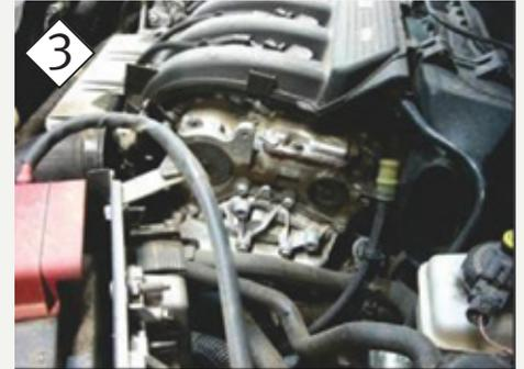
2 - Retirar las bobinas y bujías. Esta operación es importante, pues la compresión del motor influencia en el correcto ajuste de la correa (Figura 4).
