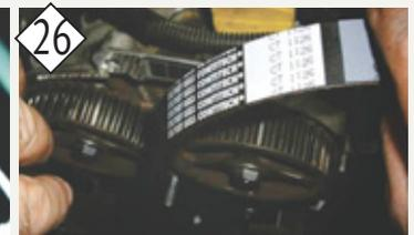
12 - Colocar la correa dentada en sentido anti-horario, colocar nuevamente la herramienta N° 151002 para trabar los engranajes de los comandos que están sueltos (Figura 26).
