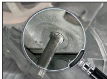
**Fig. 1:** El espárrago no está roscado correctamente
