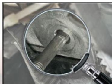
**Fig. 2:** El espárrago está roscado correctamente
