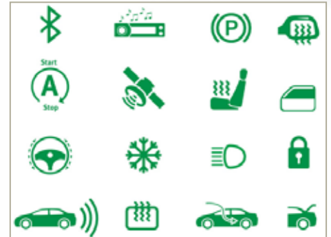
Ejemplos de símbolos indicativos del Circuito Accesorio en los paneles de algunos vehículos
